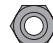
Z663 Lock Nut M3 Stoppmutter M3 Ecrou nylon M3 ナイロンナット M3
